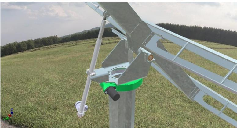
Proceder ao aperto do Actuador Linear no Cabeçote com a Viga na Horizontal.
