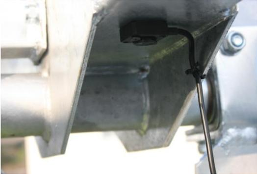
Colocar Inclinómetro por baixo da Viga Central, do lado Norte, sempre com o cabo para o lado Direito.
