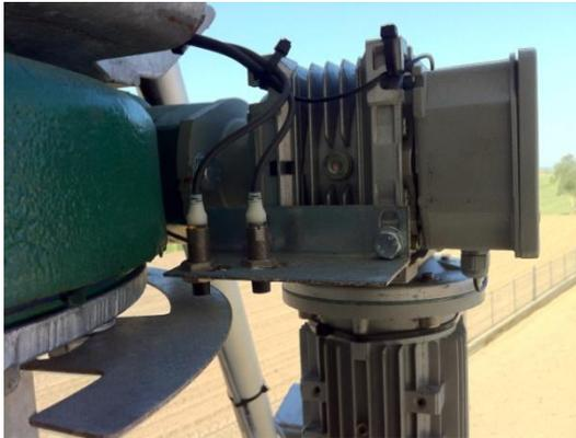
Colocar os 2 Sensores, Posicionamento e Emergência Azimutal, conforme imagem ao lado.
