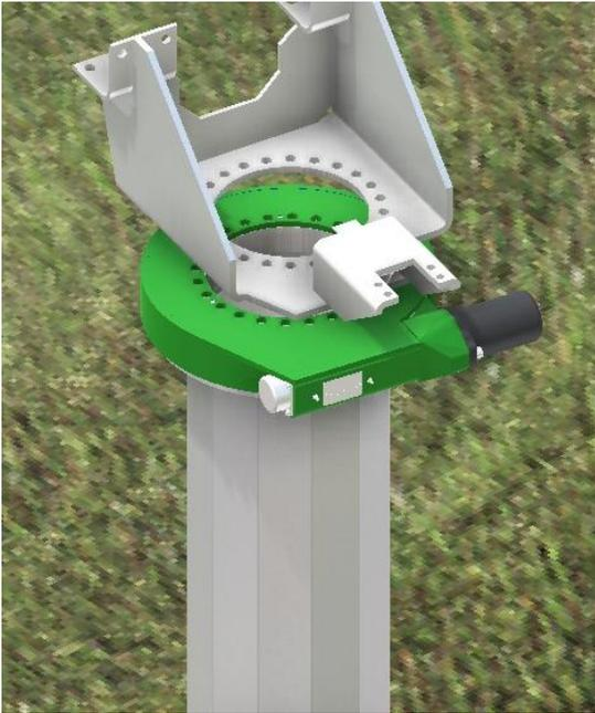
O Cabeçote é aparafusado à Coroa pela parte de cima, conforme figura ao lado.
