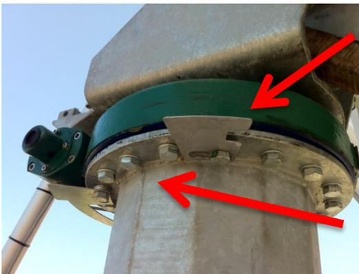
Colocar a Chapa de Emergência de forma a que actue a cerca de  $-135^{\circ}$ .
